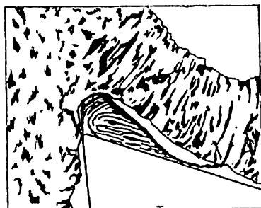
Рис. III.5. Нарост при резании стали.
