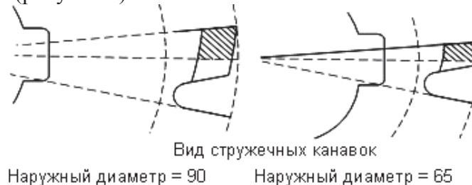
Рисунок 2 Ограничение минимального наружного диаметра фрезы
