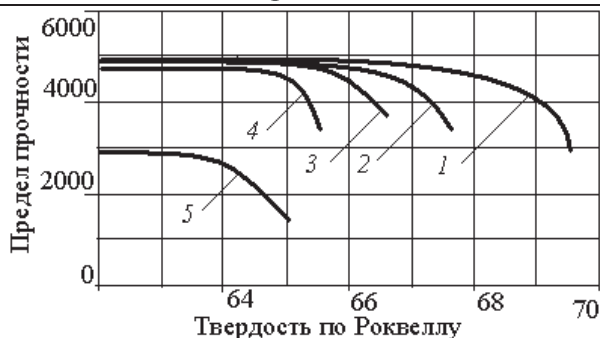
Рисунок 7. Свойства различных быстрорежущих сталей: 1 – REX121; 2 – S380; 3 – REX76; 4 – порошковая БРС; 5 – обычная БРС
