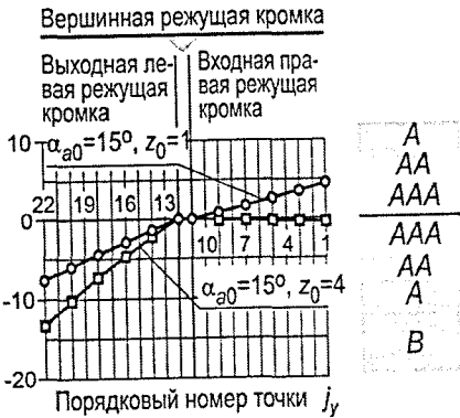
Рисунок 5 - Влияние переточек червячной фрезы с m = 4 мм, \alpha_{n0} = 20^\circ на точность профиля режущих зубьев при профилировании фрезы в технологическом корпусе
