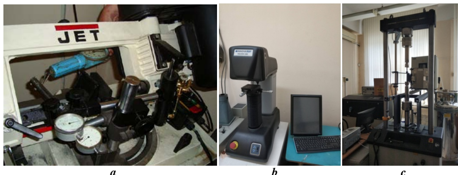
Рис. 1. Оборудование, использовавшееся при проведении исследований: а – ленточнопильный станок JET; б – микротвердомер Falcon 500; в – Instron 8801
