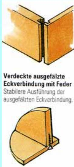
Verdeckte ausgefälzte Eckverbindung mit Feder
