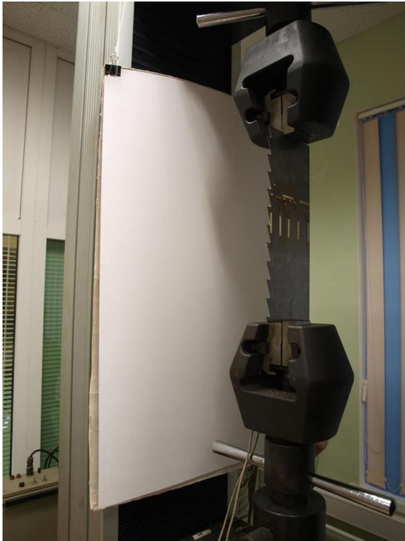
Рисунок 3.3. Установка образца ленточной пилы в захватах
