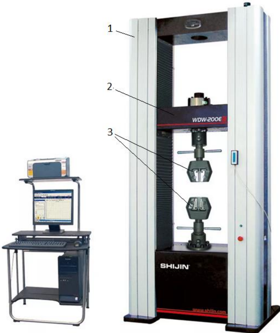
Рисунок 3.2. Экспериментальная универсальная испытательная машина WDW – 200E: 1 – станина, 2 – траверса, 3 - захваты
