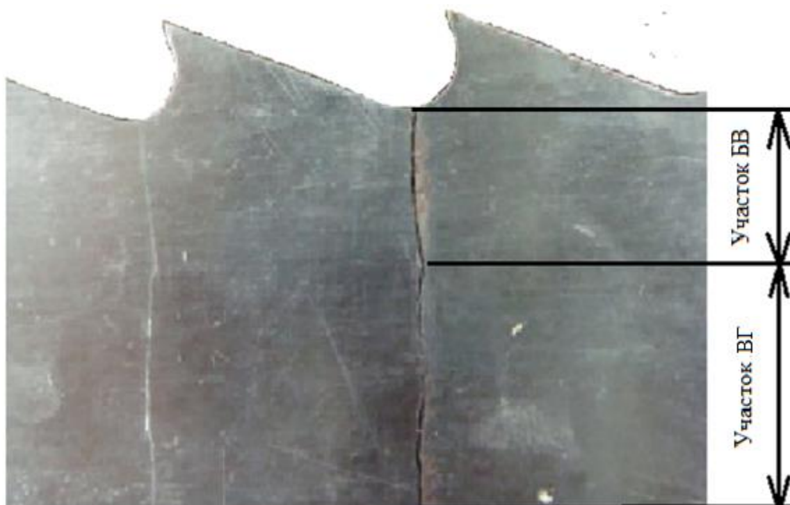
Рисунок 5.1. Усталостные трещины в ленточной пиле при испытаниях
