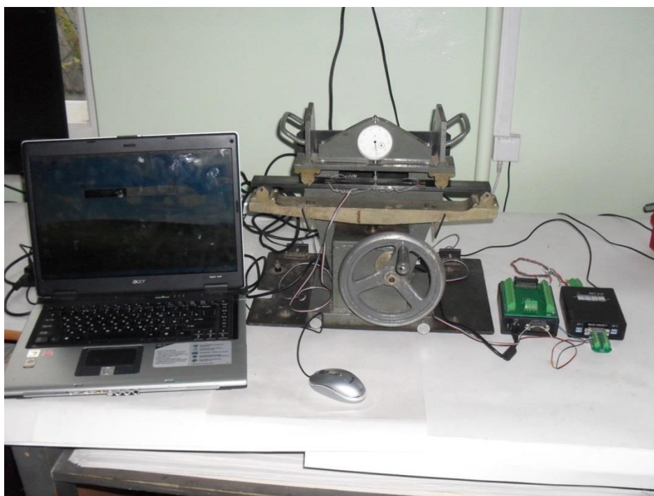
Рисунок 2.4 - Измерительный комплекс для градуировки тензодатчиков
