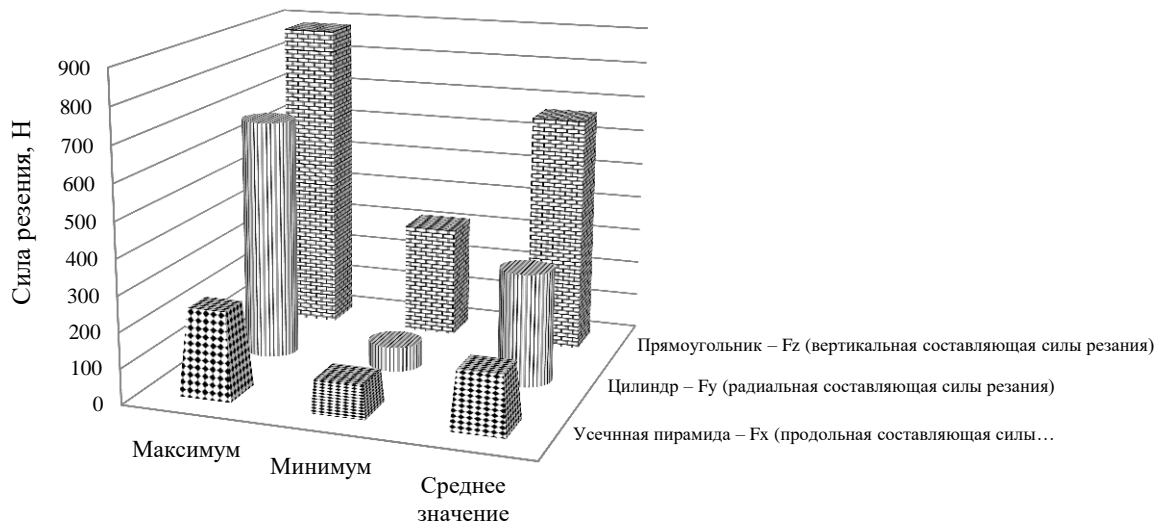
Рисунок 34 – Графическая иллюстрация результатов записи сил резания при обработке стали марки 13X15H5 АМ-3 трёхгранной сменной пластиной из ВК8: а – запись составляющих силы резания; б – номограммы соотношения составляющих силы резания; в – номограммы соотношения максимальных значений составляющих силы резания (скорость резания 50 м/мин, глубина резания 1 мм, подача 0,21 мм/об.заготовки)
