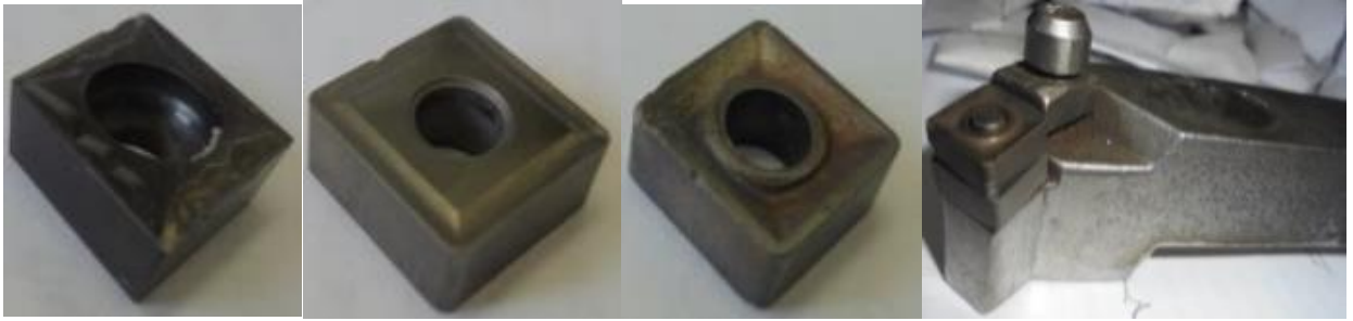
Рисунок 39 – Примеры режущих пластин и их расположение в токарном проходном резце (первые слева два фото – импортные пластины, остальные фото – отечественная типовая пластина)
