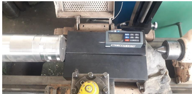
Рисунок 56 – Иллюстрация измерений шероховатости на станке: а – расположение измерительного устройства на стойке; б – этап подвода щупа измерительной головки к заготовке
