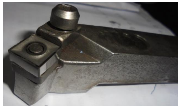
Рисунок 36 – Сравнительная оценка периода стойкости инструментальной основы (субстрата) марки ВК8 при разных приёмах (а) упрочнения; б – внешний вид режущей пластины, подвергнутой термозаточке и полированию: 1 – ВК8 подвергнутый термозаточке и полированию; 2 – ВК8 +Ti(до 1мкм) + TiN(1мкм) + (NbZrTiAl)N(2,5 мкм) [нанесение слоёв покрытия методом конденсации ионной бомбардировкой (КИБ) с фильтрацией капельной фазы и при ассистировании ускоренными ионами]; 3 – ВК8 + Ti(до 1мкм) + TiN(1мкм) + (TiAl)N(2 мкм) + TiN(0,5 мкм)[нанесение слоёв покрытия
