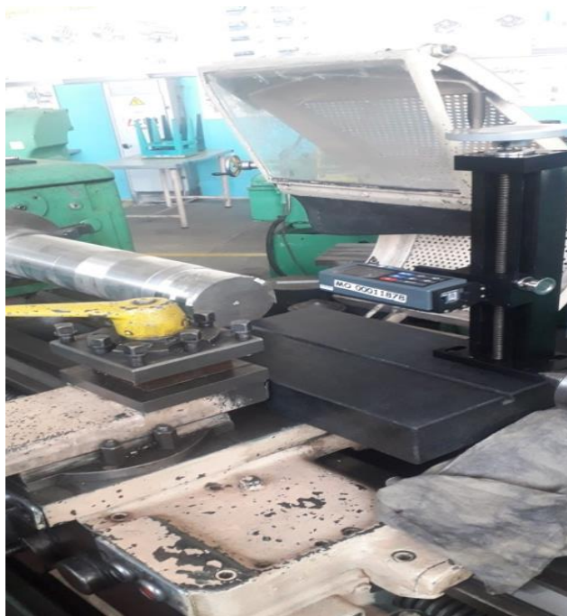
Рисунок 24 – Фотографии обустройства токарного станка для проведения: а – продольного точения заготовки; б – измерения составляющих силы резания при замене резцедержателя станка токарным динамометром STD201-2; в – измерения параметров шероховатости обработанной поверхности
