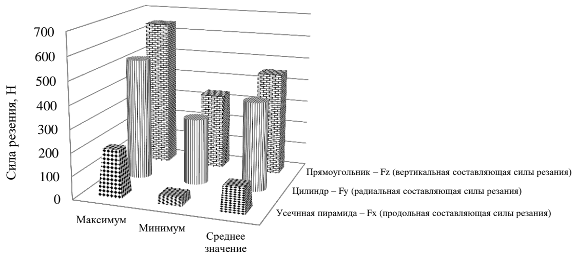
Рисунок 30 – Графическая иллюстрация результатов контроля сил резания при обработке стали марки 13X15H5 АМ-3 квадратной сменной пластиной из ВК8 (в состоянии поставки): а – запись составляющих силы резания; б – номограммы соотношения составляющих силы резания; в – номограммы соотношения максимальных значений составляющих силы резания (скорость резания 50 м/мин, глубина резания 1 мм, подача 0,21 мм/об.заготовки)
