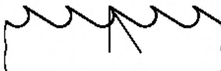
Рисунок 8 — Форма с положительным передним углом
