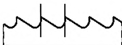
Рисунок 6 — Нормальная или стандартная форма зубьев
