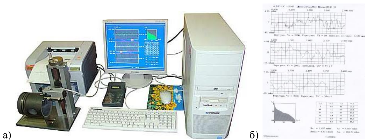
Рис. 2.9. Профилограф-профилометр Абрис-ПМ7: а) общий вид; б) протокол измерения
