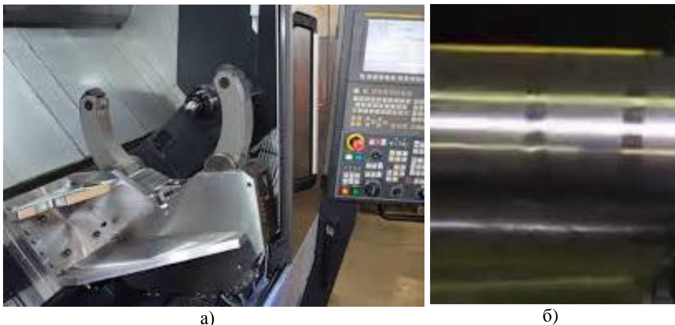
Рис. 1.3. Пример обработки с самоцентрирующимся люнетом: а) общий вид люнета, установленного на станке; б) проявление явления накатывания поверхности роликами самоцентрирующих люнетов на детали.
