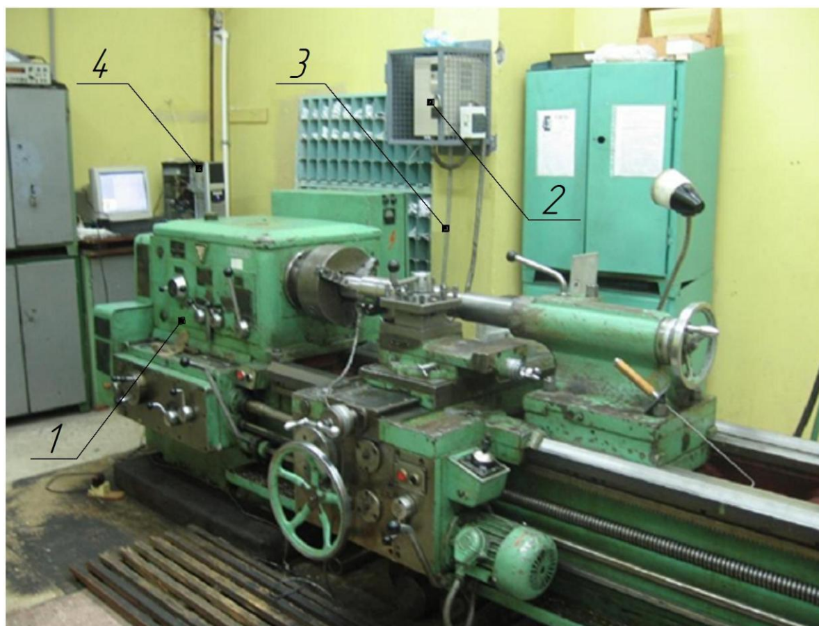
Рис. 2.1. Общий вид станка модели 1М63 : 1 - станок; 2 - векторный преобразователь частот; 3 - интерфейсный кабель; 4 - персональный компьютер
