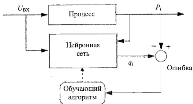
Рис. 1. Схематичное представление технологического процесса фрезерования с использованием нейронной сети
