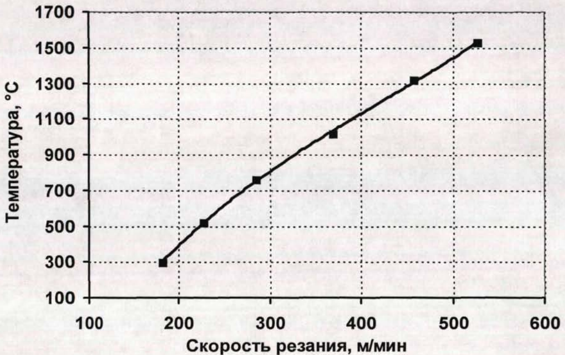
Рис. 3.6. Зависимость температуры стружки от скорости резания при фрезеровании титанового сплава ВТ3 ( s=0,05 мм/зуб; t=1 мм)
