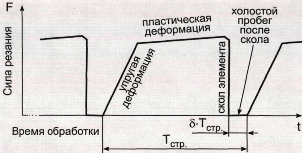
Рис. 4.13. График изменения силы резания при образовании элементной стружки.
