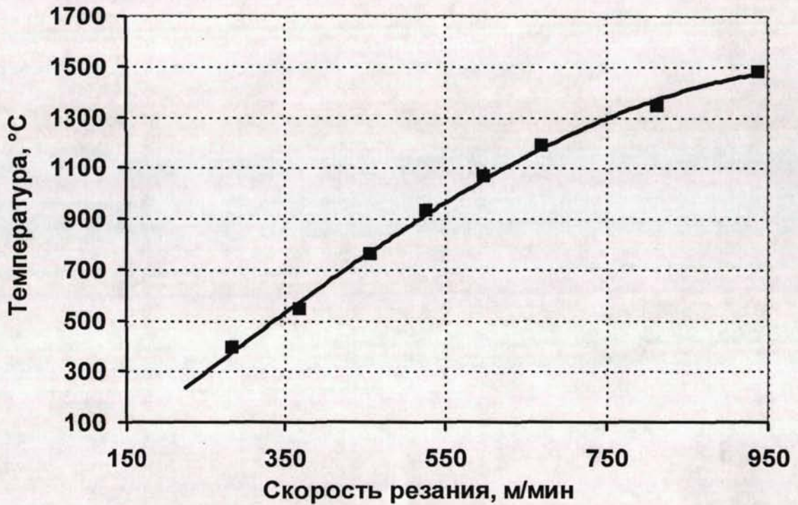
Рис. 3.4. Зависимость температуры стружки от скорости резания при фрезеровании закаленной стали 40X ( s=0,05 мм/зуб; t=1 мм)
