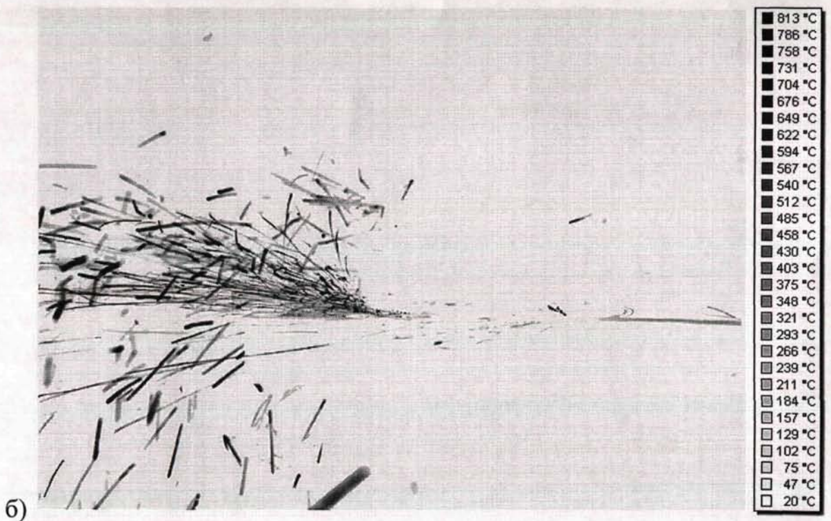
Рис. 2.8. Фотографии процесса высокоскоростного фрезерования закаленной стали 40X твердостью 52HRC (а) и температурная картина (б), полученная из RAW-изображения. Режимы резания: V = 428 м/мин, S = 0,05 мм/зуб, t = 1 мм.
