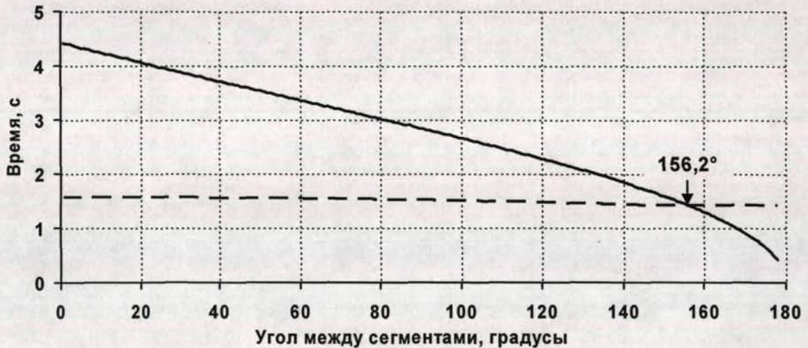
Рис. 5.11. График зависимости времени прохождения двух смежных линейных сегментов траектории: со сплайн-скруглением (сплошная линия) и с торможением-разгоном на изломе (пунктир).
