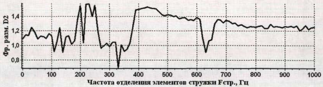
Рис. 4.20. График зависимости D_2 от частоты образования элементов стружки F_{\text{стр.}} при значении скорости резания V_{\text{рез.}} = 42 м/мин.
