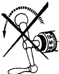
Рис. 59. Лимб поперечной подачи и его использование.
