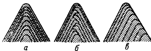
Фиг. 256. Образование винтовой канавки резьбы при различных способах углубления резца.
