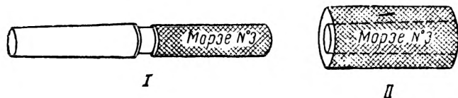
Фиг. 183. Калибр-пробка ( I ) и калибр-втулка ( II ) для проверки конусов
