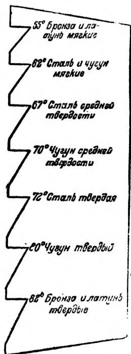
Фиг. 44. Шаблон для проверки углов резцов
