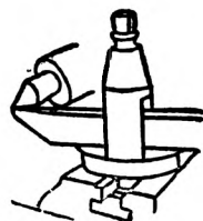
Фиг. 108. Установка резца по центру
