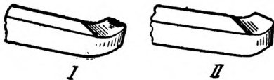
Фиг. 355. Проходные резцы: старого образца ( I ) и образца, применяемого тов. Лихорадовым ( II ).
