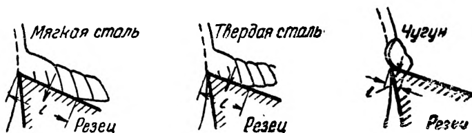
Фиг. 386. Давление стружки на резец в зависимости от ее формы.
