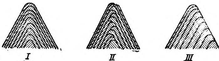
Фиг. 230. Образование впадины резьбы в зависимости от способа углубления резца
