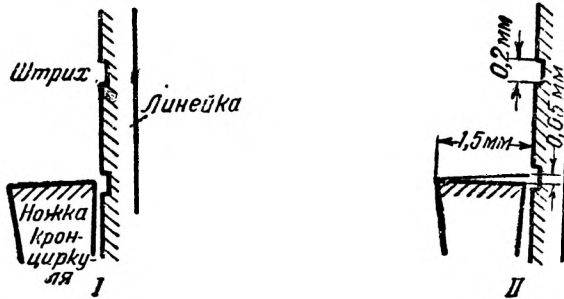
Фиг. 319. Ошибка в отсчете по линейке при неправильной установке ее относительно глаза измеряющего.
