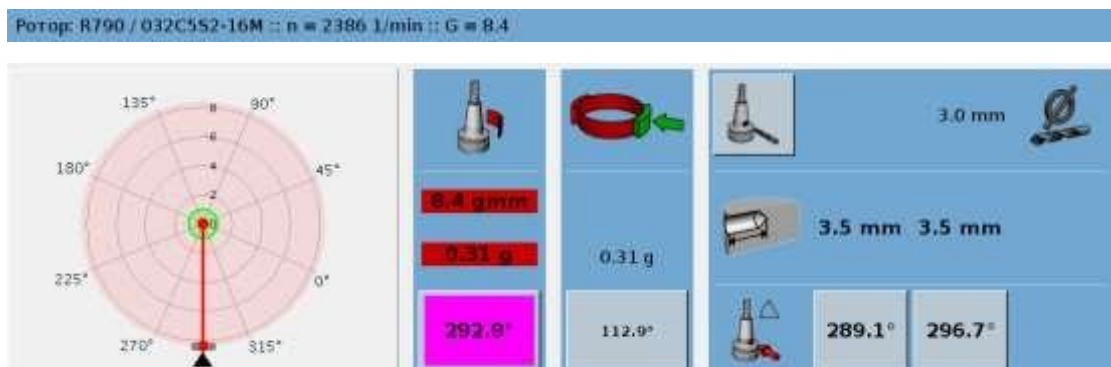
Рисунок 3.16 – Остаточный дисбаланс инструментальной наладки R790-032C5S2-16M, качество балансировки для частоты вращения 20200 мин -1
