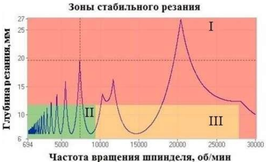
Рисунок 3.11 – График областей стабильного резания для фрезы R790-032C5S2-16M
