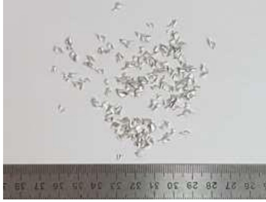
Рисунок 4.2 – Результаты проведения экспериментов: а – получаемая стружка; б – обработанная поверхность
