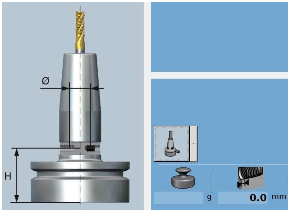
Рисунок 1.17 – Балансировка при помощи винтов
