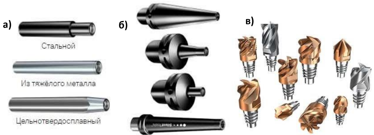
Рисунок 1.8 – Модульная система для закрепления вращающегося инструмента: а) – переходники б) - адаптеры, в) – фрезерные головки [11]
