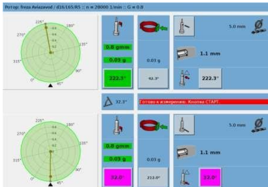
Рисунок 3.36 – Результаты балансировки инструментальной наладки AZ-3D16R6L65, качество балансировки для частоты вращения 28000 \text{ мин}^{-1}
