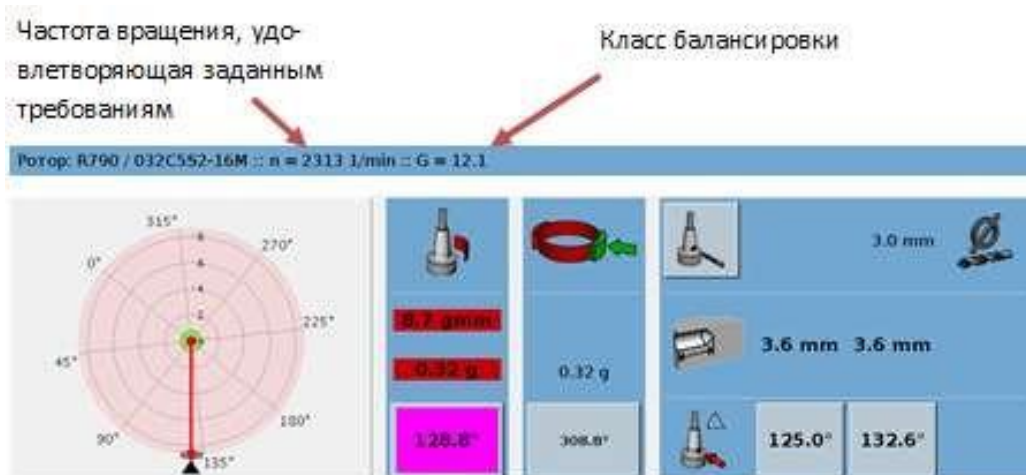
Рисунок 3.2 – Качество статической балансировки инструментальной наладки R790-032C5S2-16M согласно требованиям ISO 1940-1
