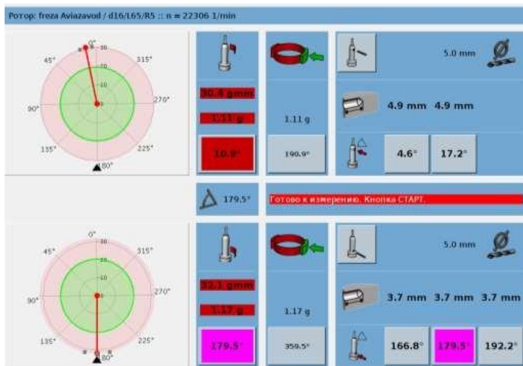
Рисунок 3.6 – Качество динамической балансировки инструментальной наладки AZ-3D16R6L65 согласно требованиям DIN 69888
