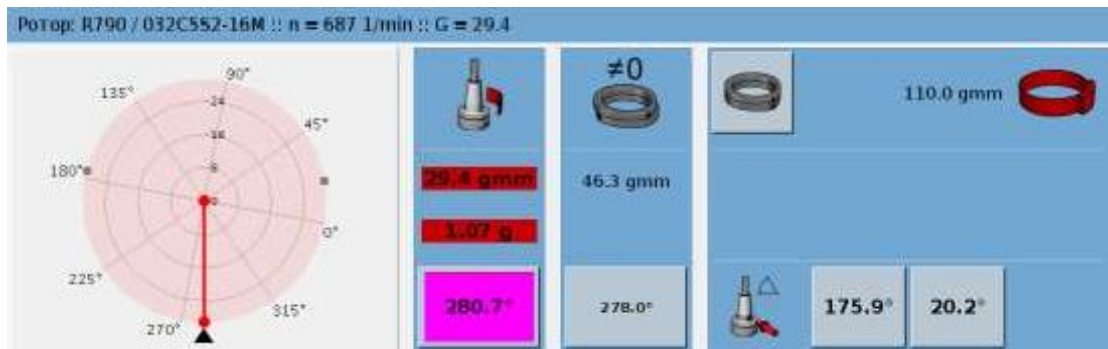
Рисунок 3.24 – Остаточный дисбаланс инструментальной наладки R790-032C5S2-16M, качество балансировки для частоты вращения 20200 мин -1
