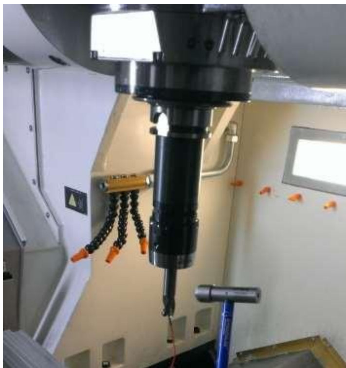
Рисунок 3.9 – Таре-тест инструментальной наладки AZ-3D16R6L65 в обрабатывающем центре HSC 75 linear
