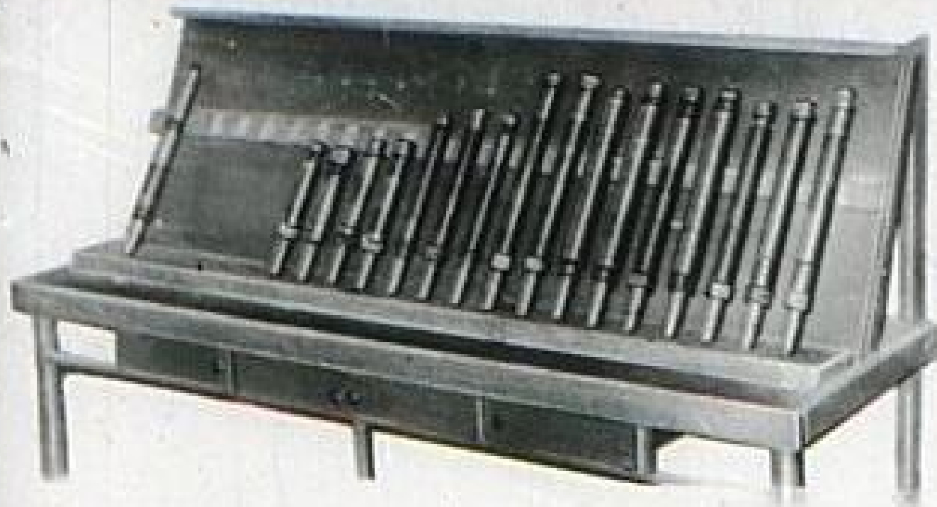
Стенды для хранения фрезерных оправок и фрез
