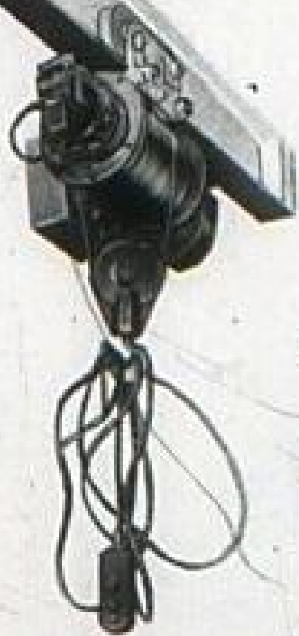
Тельфер грузоподъемностью 0,5 т
