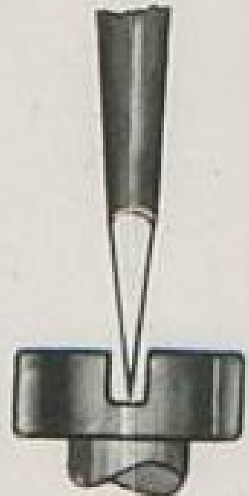
Правильная и неправильная заточка лезвия отвертки
