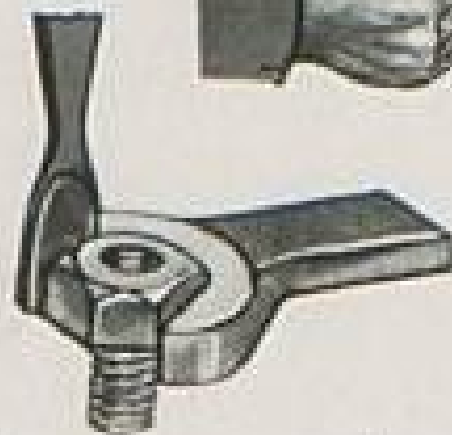
Недопустимые способы отвинчивания гайки
