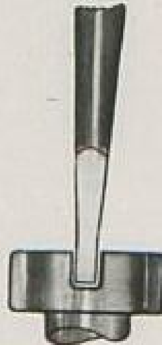
Правильная и неправильная заточка лезвия отвертки
