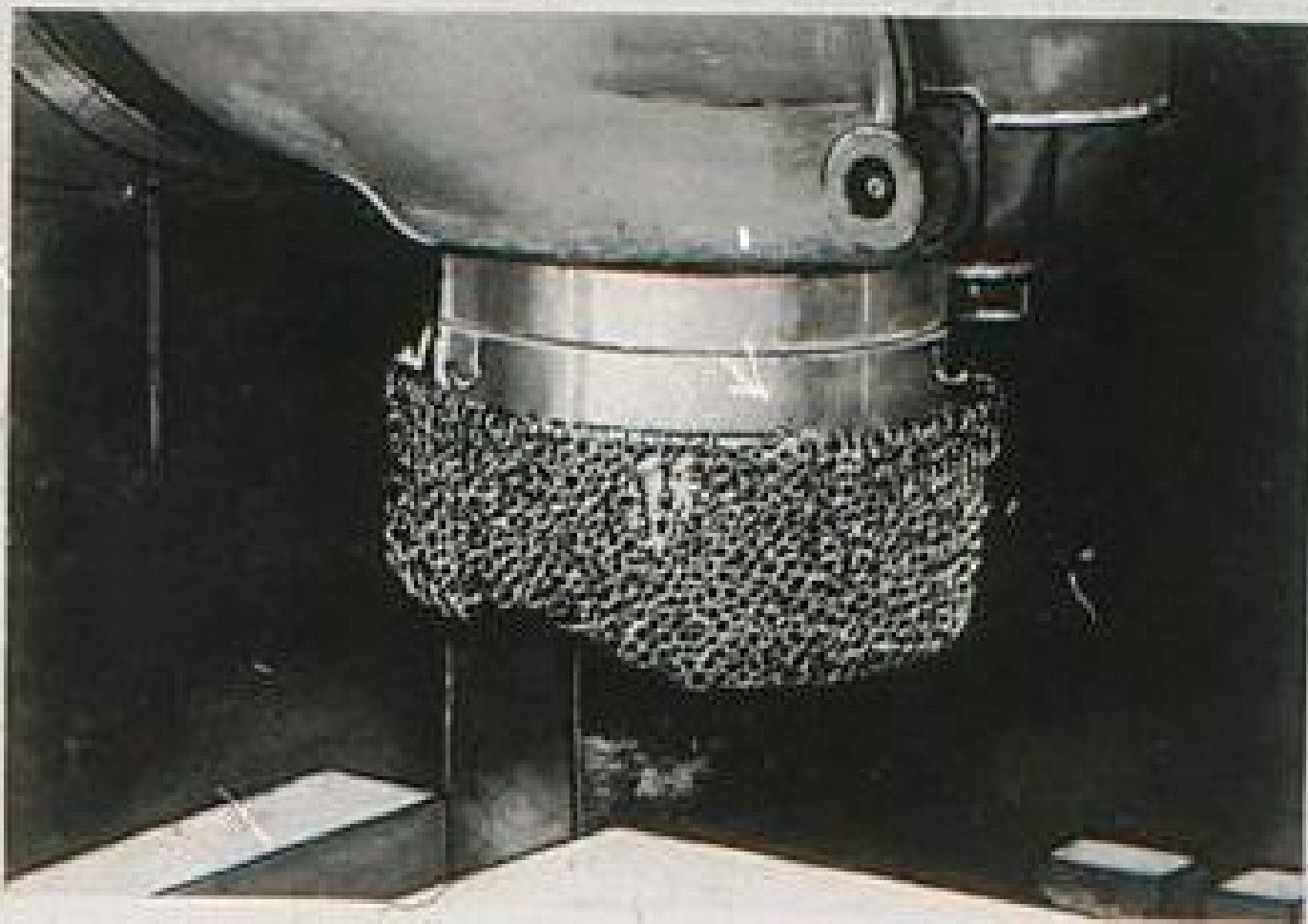
Ограждение фрезы кольчужного типа для вертикальнофрезерного станка
