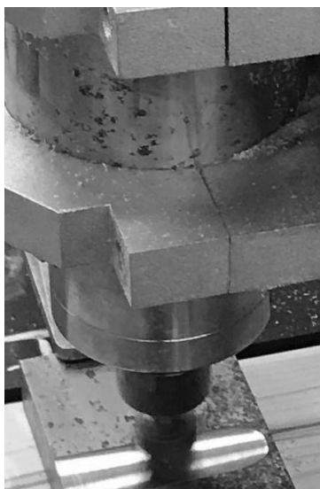
Рис. 4.11. Обработка стальной пластины на мобильном фрезерном оборудовании, предназначенном для алюминиевых сплавов
