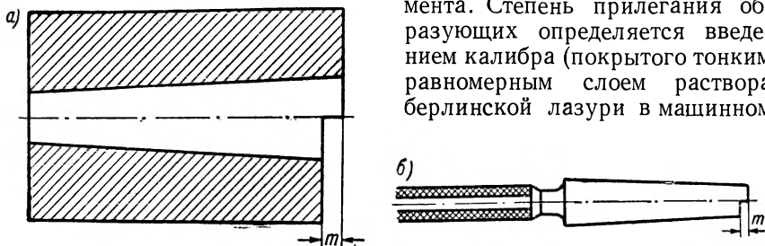
Рис. 150. Калибры для гладких изделий: а — кольцо для измерения наружных поверхностей; б — пробка для измерения внутренних поверхностей.
