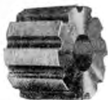
Фиг. 17. Цилиндрическая групповая резьбовая фреза для коротких нарезок.
