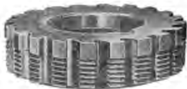
Фиг. 22. Групповая цилиндрическая фреза для коротких внутренних нарезок и одновременной обработки выточек.
