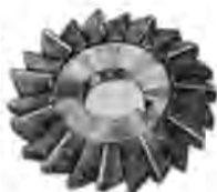
Фиг. 23. Дисковая резьбовая фреза для трапециoidalной резьбы.
