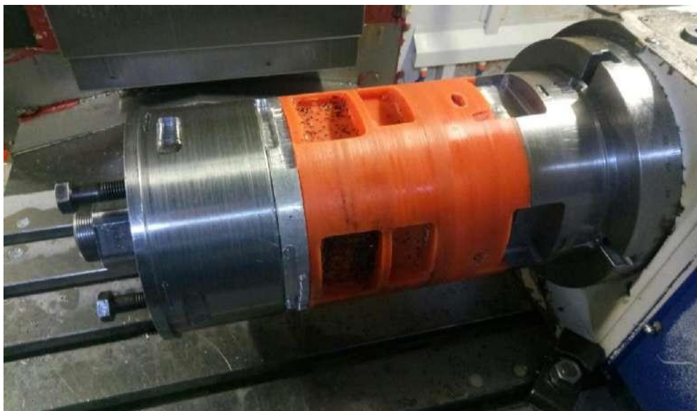
Рисунок 3.29 – Оправка с повышенной виброустойчивостью
