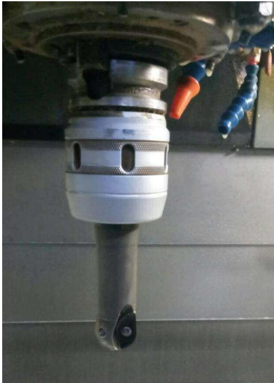
Рисунок 2.2 - Сферическая корпусная фреза RVH BCF3028S32-160 со сменными пластинами ZCET 150CE на 4-х координатном станке с ЧПУ “Akira seiki performa v4 xp”
