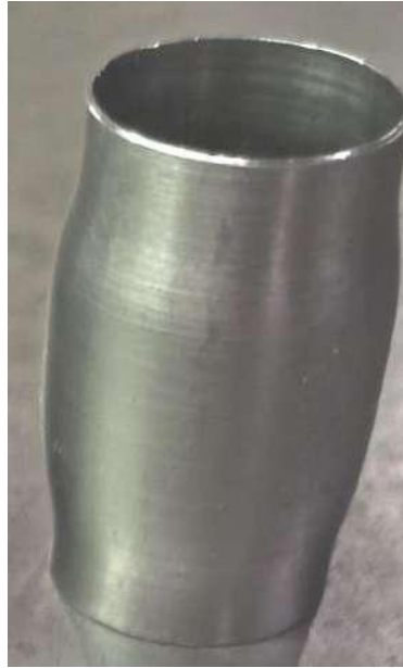
Рисунок 3.24 – Пластически деформированная стальная втулка под действием трехосного сжатия резины при осевом перемещении подвижного плунжера на 7 мм
