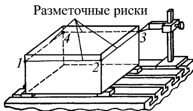
Рис. 5.6. Схема выверки заготовки на столе фрезерного станка
