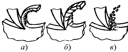
Рис. 1.6. Виды стружек: a – сливная; б – скалывания; в – надлома
