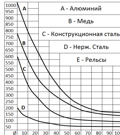
Режимы сверления (об/мин) для HSS фрез
